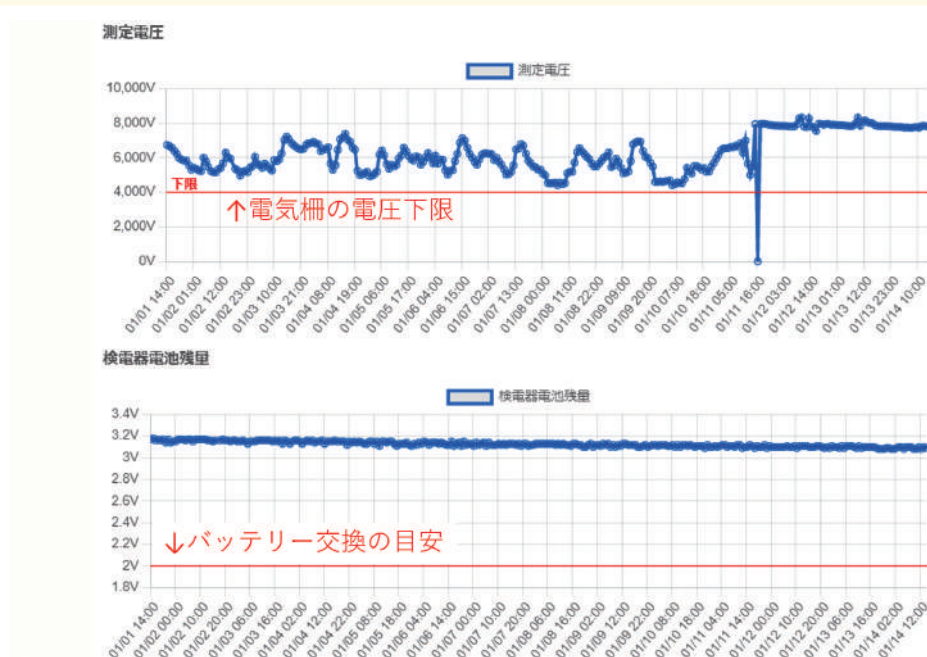
図2 電気柵の電圧（上段）と本器バッテリー（下段）の電圧値の確認画面
