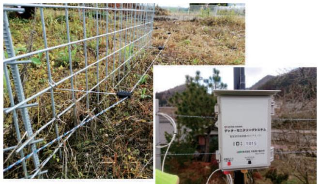
図4 メッシュ碍子R100と電圧通知機能付き電気柵システム (販売:末松電子製作所)
