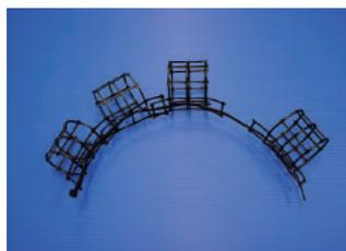
②丸めたT字部品の網目を結束バンドで縫うことで組み合わせる。直径10cm程度の樹木には、この状態のまま巻きつけ、結束バンドを閉じることで取り付ける。
