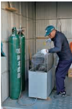
ゴミ処理施設内に整備されたアライグマ処理施設。箱わなごと装置に入れ、炭酸ガスを充填する
