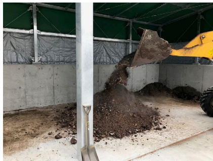
重機による切返し状況
