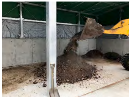
重機による切返し状況
