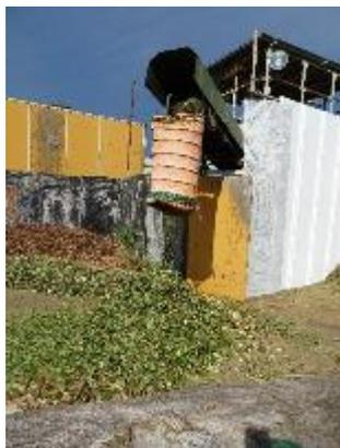
① 葉の部分風力選別機で飛ばして別保管し、葉はポット苗の会社に供給する。
