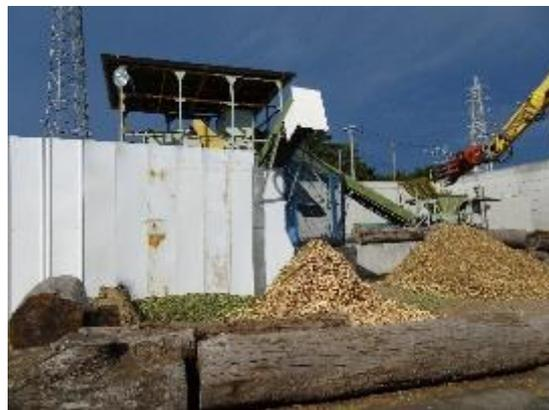
② 枝の部分破碎してチップ化し、木質バイオマス発電燃料用に供給する。
