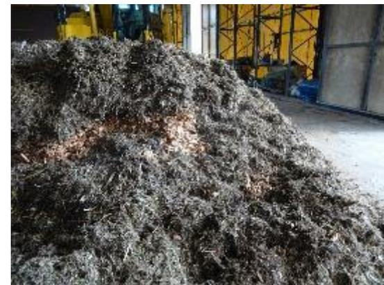
③ 燃料利用。白く見えるのは、間伐材を10%混ぜ、カロリー調整をしている。
