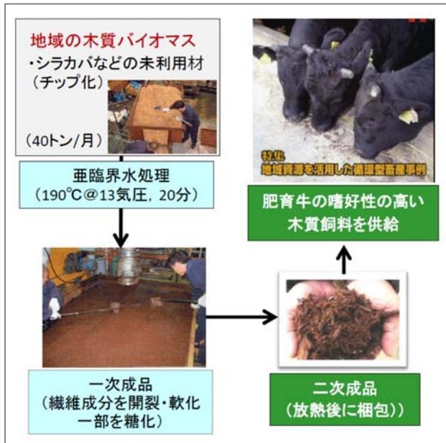
(上) 亜臨界水処理による木質飼料製造工程
