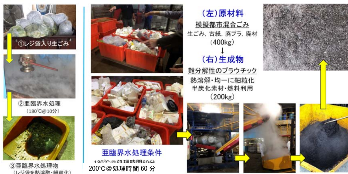
図 3-2-2 生ごみ・都市ごみ(プラスチック混合)の亜臨界水処理試験事例
