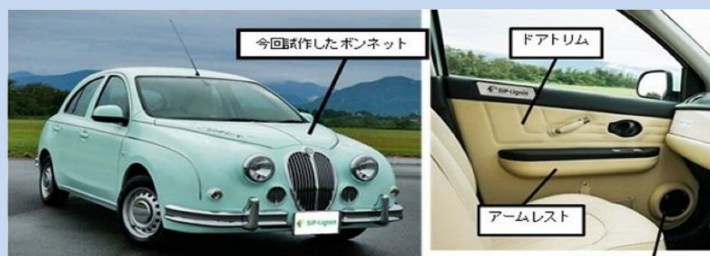
改質リグニンを内外装部品に用いた自動車 (宮城化成、産総研、光岡自動車、森林総研)
