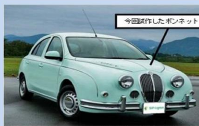
改質リグニンを内外装部品に用いた自動車 （宮城化成、産総研、光岡自動車、森林総研）
