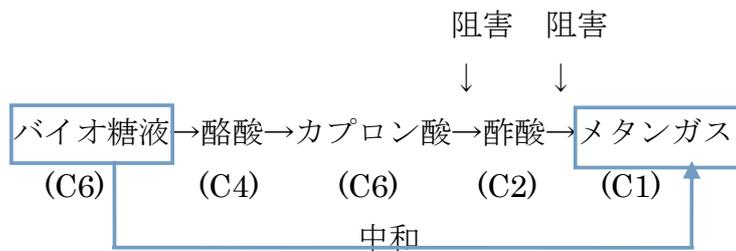
図 4-1-1 メタン発酵反応のスキームメカニズム
