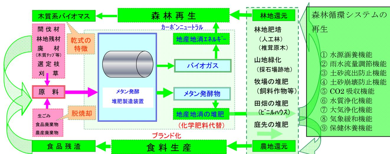
図 4-4-1 バイオマス循環モデル(メタン発酵堆肥化)構想の概要
