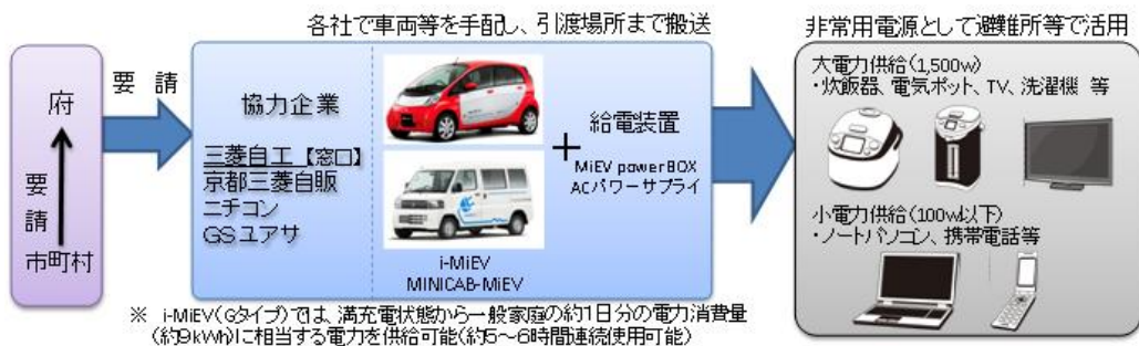
(EV を活用した災害時電力供給 出所：三菱自動車ホームページ)
