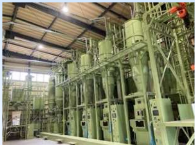
▲左／酒米1粒の99パーセント以上を磨くことができる高性能精米機 右／契約栽培米
