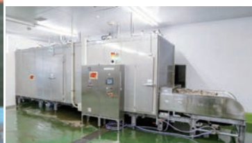
▲連続式プロトン凍結機で急速冷凍されたかきは、解凍時のドリップ量が約20%も減らせることが可能
