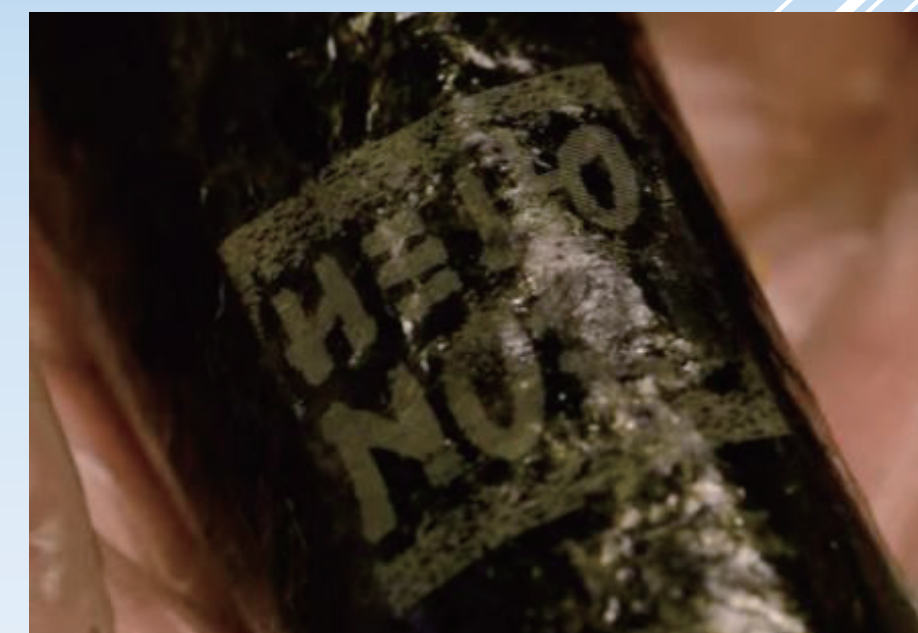
▲カナダのハンドールチェーン用 にレーザー加工を施した海苔
