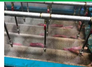
腐敗防止のための洗浄方法の実証
