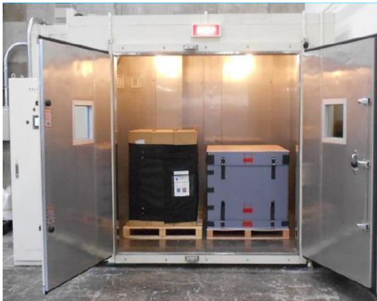
コンテナ輸送による品質影響試験
