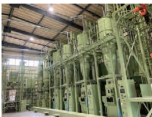
▲左／酒米1粒の99パーセント以上を磨くことができる高性能精米機 右／契約栽培米
