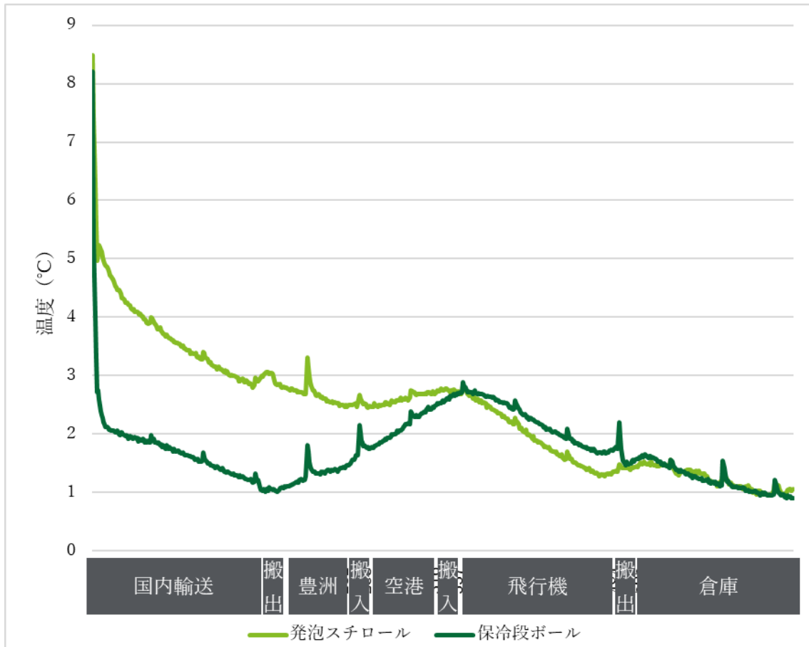
図 3-14 飛行機×チルドにおける发泡スチロールと保冷段ボールの温度推移イメージ
