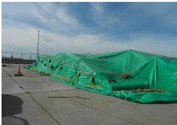
(木材天幕くん蒸の様子 (コンテナ積み用))
