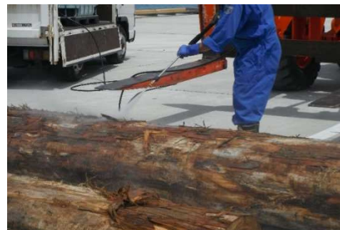
図 高圧洗浄機による土壌除去作業
