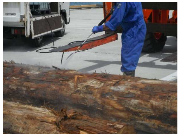
（高圧洗浄機による土壌除去作業）
