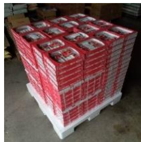
輸送時のパレットの工夫（熱が伝わりにくい素材の使用）
