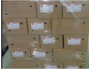
穴の空いた専用資材を使って 船便での湿気対策
