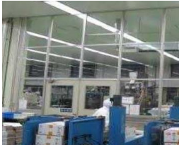
空気を経由した汚染の防止設備 (パーティション) の導入
