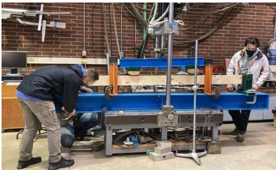
米国検査機関でのヒノキの強度試験（令和3年11月）
