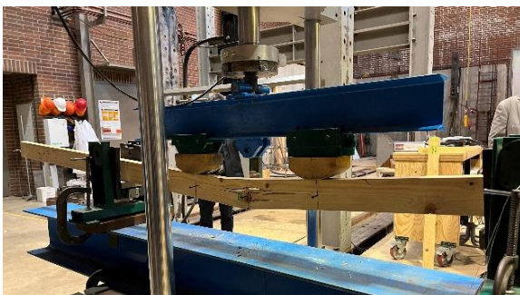
米国検査機関でのスギの強度試験 (令和5年11月、米国オレゴン州立大学)
