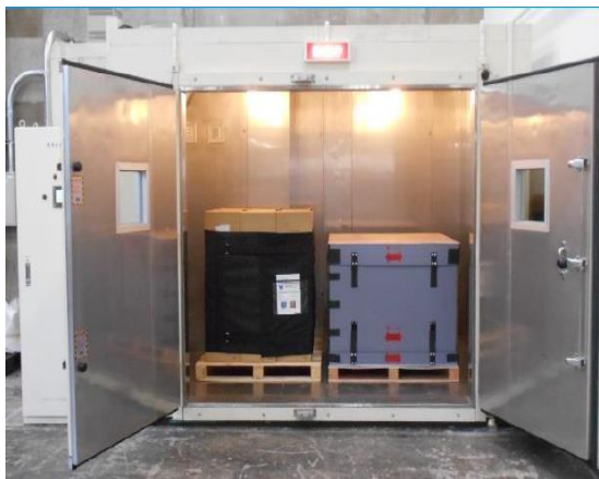
コンテナ輸送による品質影響試験
