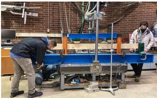
米国検査機関でのヒノキの強度試験（令和3年11月）
