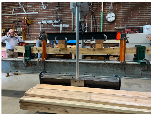
(米国検査機関でのスギの強度試験 令和6年6月(米国オレゴン州 オレゴン州立大学))
