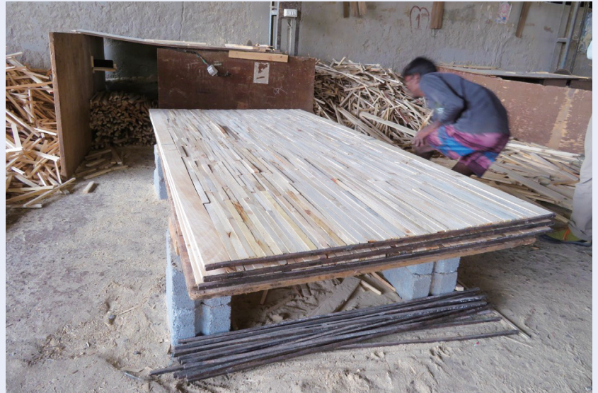
(ブロックボードの作成風景)
