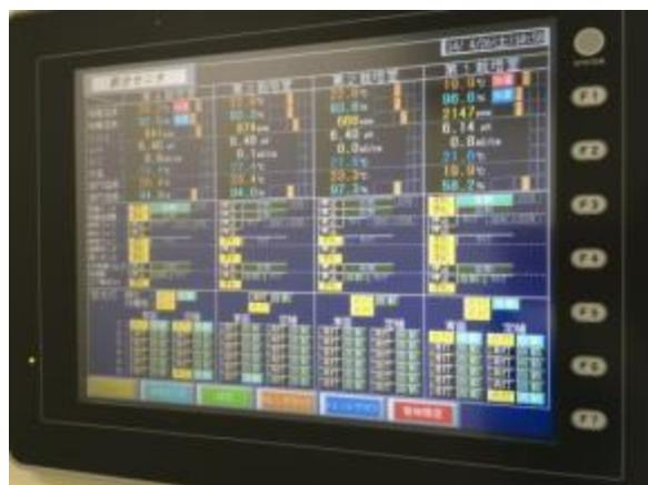
照明、温度、湿度、気流、CO2濃度、栽培溶液のpH、EC、ポンプの稼働などはすべてコントロールパネルで操作できます
