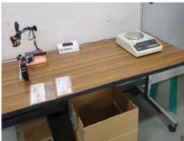
写真3-1 (左) 厚さ検査、(右) 重量検査
