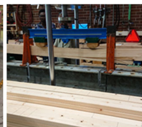
構造材輸出開始に向けたスギ・ヒノキ製材の性能検証
