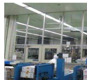
空気を經由した汚染を防止する設備（パーティション）の導入
