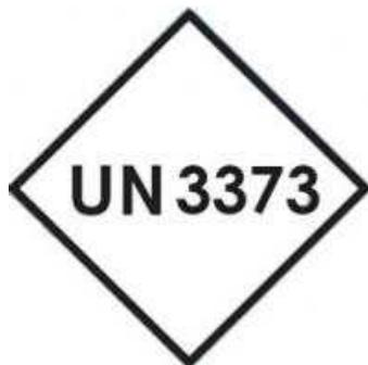
・最小寸法：四角を構成する線の幅は2mm以上とし、文字と数字の高さは6mm以上とする。航空輸送の場合は、四角の各辺の長さが少なくとも50mm以上でなければならない。
