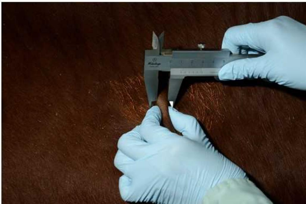
図4 ノギスによる皮膚の厚さの測定
