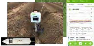
写真、土壌水分センサー埋設の様子
