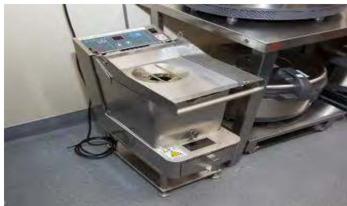
天かす搾油機による廃棄量削減
