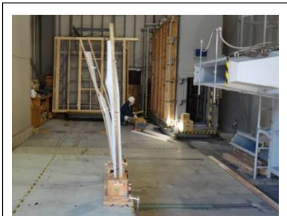
Fig. 2 木製支柱の耐風試験（風速 56m/s×20 分間）
