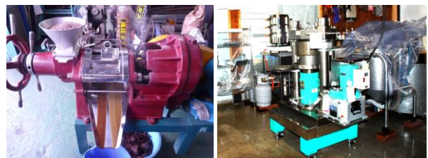
図2. スクリュー式圧搾機(左)と小型電動圧搾機(右)
