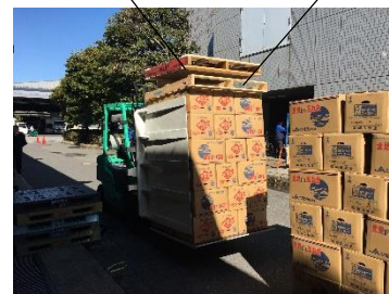
③元のパレットAと積荷の間に別のパレットBを装着する
