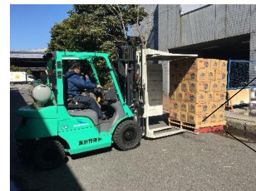
④もう一度上下逆さまにして据え置き、Bのパレットで積荷を運び出せば、Aのパレットを回収可能
