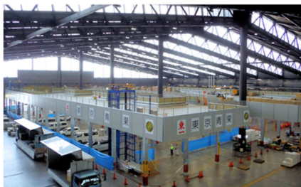
1階は空調機とカーテン設置で定温保管可能 2階へは垂直搬送機で荷を移動
