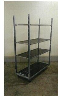
(写真左) フル台車 : W1055mm×D1285mm×H2068mm
