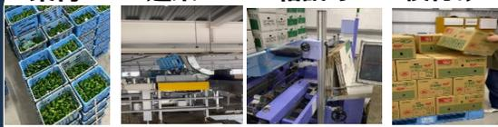
選果機への自動投入 自動段ボール組み立て
