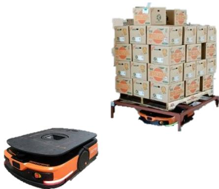
パレットを載せて、架台の下に潜り込んで、リフトのように荷物を持ち上げて搬送する**低床型AGV**を2台導入
