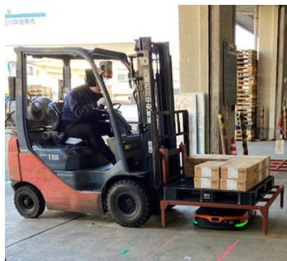
パレットに積まれたミカンを専用架台に載せる
