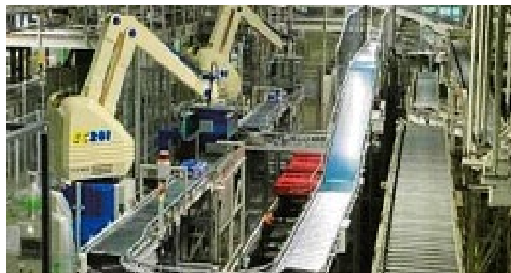
多様な積付けパターンにも対応可能な ロボットパレタイザー
