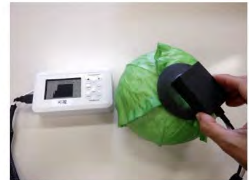
分光センサーの外観（左）と測定のイメージ（右）
