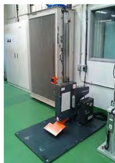
落下試験装置
