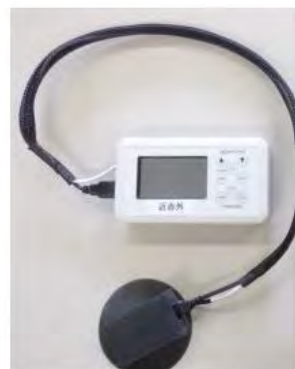
分光センサーの外観（左）と測定のイメージ（右）
