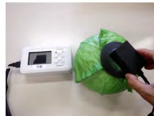
分光センサーの外観（左）と測定のイメージ（右）
