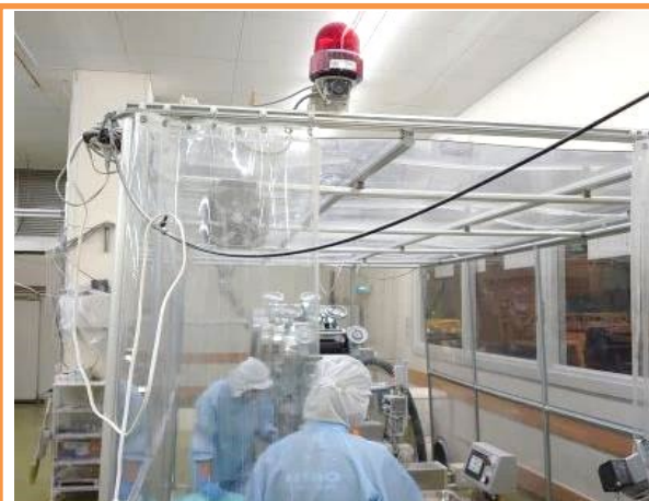
そば粉があふれる前にセンサーが感知。回転灯が起動し、サイレンが鳴る。
