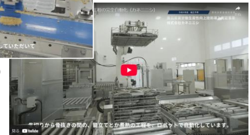
経節製造の籠立て及び煮熟工程の完全自動化（カネニシ）
