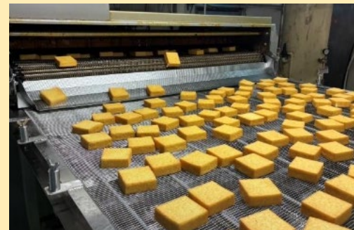
↑ 導入した国産厚揚げ製造設備
