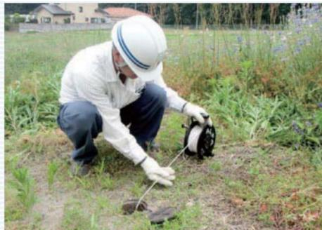
**写真 地下水位調査の実施状況**
